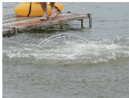
一度沈んでから浮力体が自動膨張し始める
