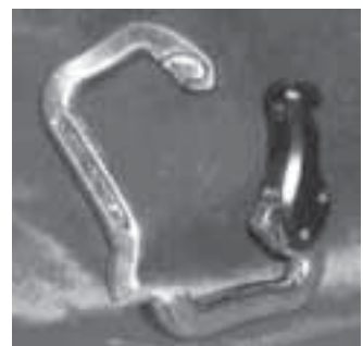
DHVホームページに掲載された 破断したカラビナ(DHV提供)
