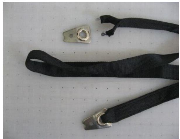
この特有なアイレットは、Icaro 2000 社によって、その製品に 20 年間使用されてきた。これが最初の破損である。点検したところ、ごく稀に、アイレットが取付けられている個所に鋭い端面が存在しうることが判明した。Icaro 2000 社は、ただちにこの種のアイレットの使用を中止した。
