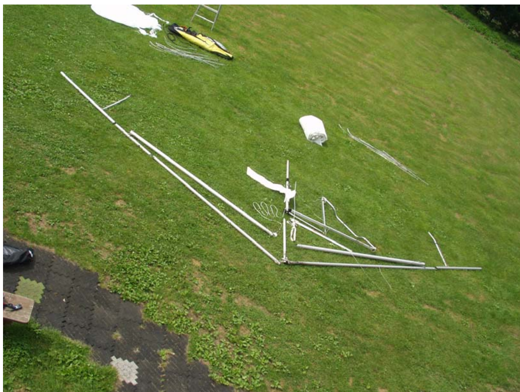
図5：骨組み。キール中央部は撮影時は行方不明。キングポストはコントロールバーの前に置いている。
