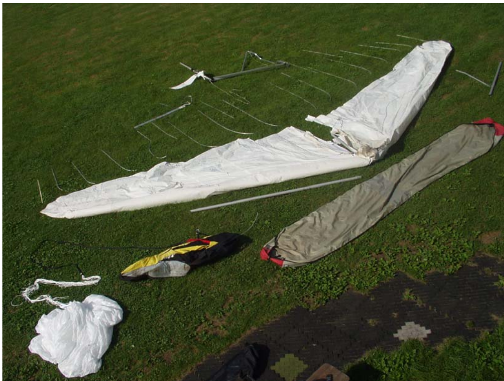
図5：骨組み。キール中央部は撮影時は行方不明。キングポストはコントロールバーの前に置いている。
