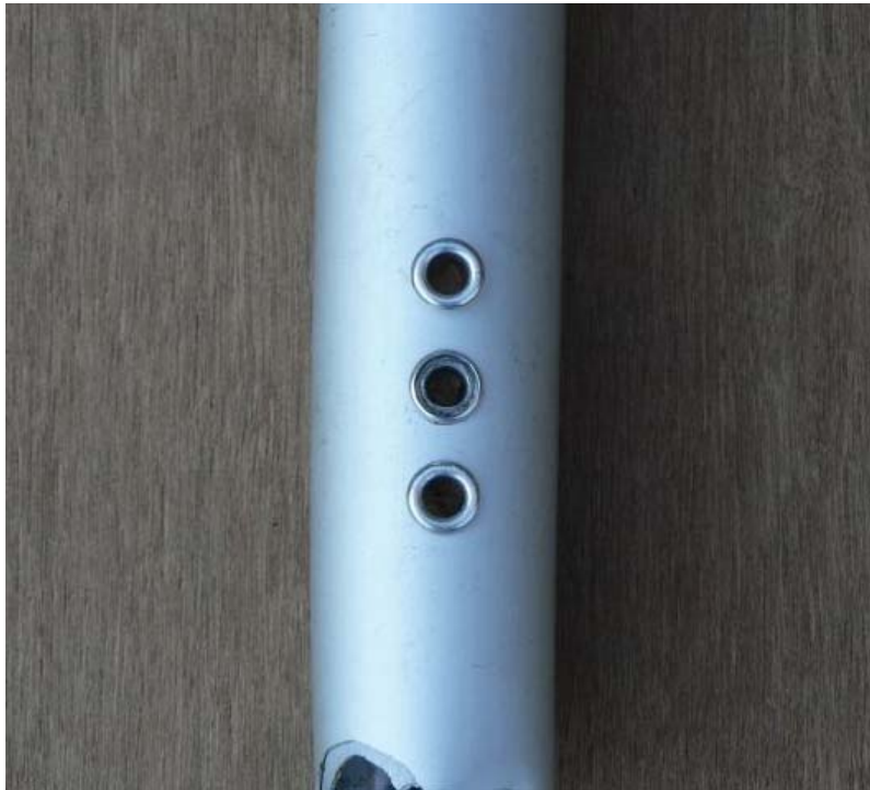
図 2 4 : トリム設定は、8 月 1 1 日に発見されたキール部品の、通常使用によると思われる痕跡から、3 段階の中位置であったと推測される。
