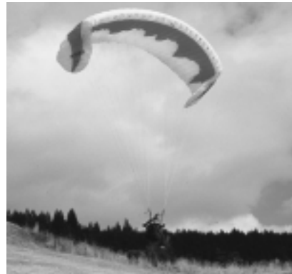
2 最終進入から高度が下がったところで、通常のブレークのタイミングより少し早めにブレークを引いて、沈下を少なくします。通常滑空より沈下速度が速いので、少し速めに減速を開始するわけです。翼端折からブレークを引いた場合、迎え角が大きくなりすぎて、最終的に失速する可能性が高くなるので、中途半端な高度でブレークを引くのは危険です。
