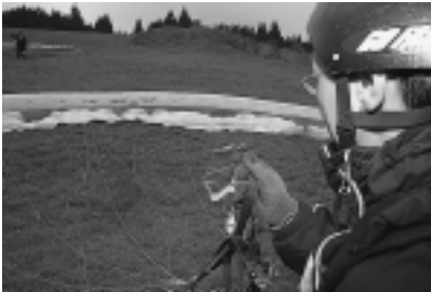
写真7 Aライザーを持つ手をほんの5cm左にずらしただけで、右翼のライン向かって左側が緩んでしまう。この状態だと左翼が最初に上がり機体は右に傾く。
