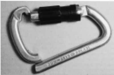
写真1 破断カラビナ
